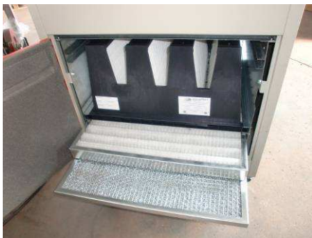
PARTICOLARE FILTRAZIONE A TASCHE RIGIDE
